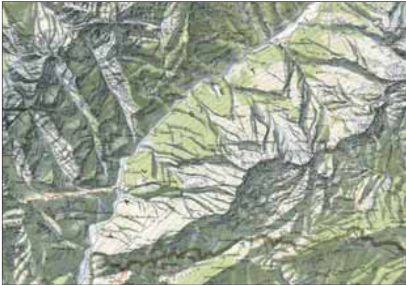
Topografia di area montana con aste torrentizie rettilinee condizionate dall'assetto strutturale della zona
